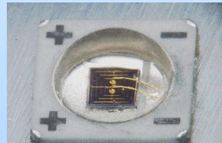
Optocoupler NASA GSFC PA Lab J16233
